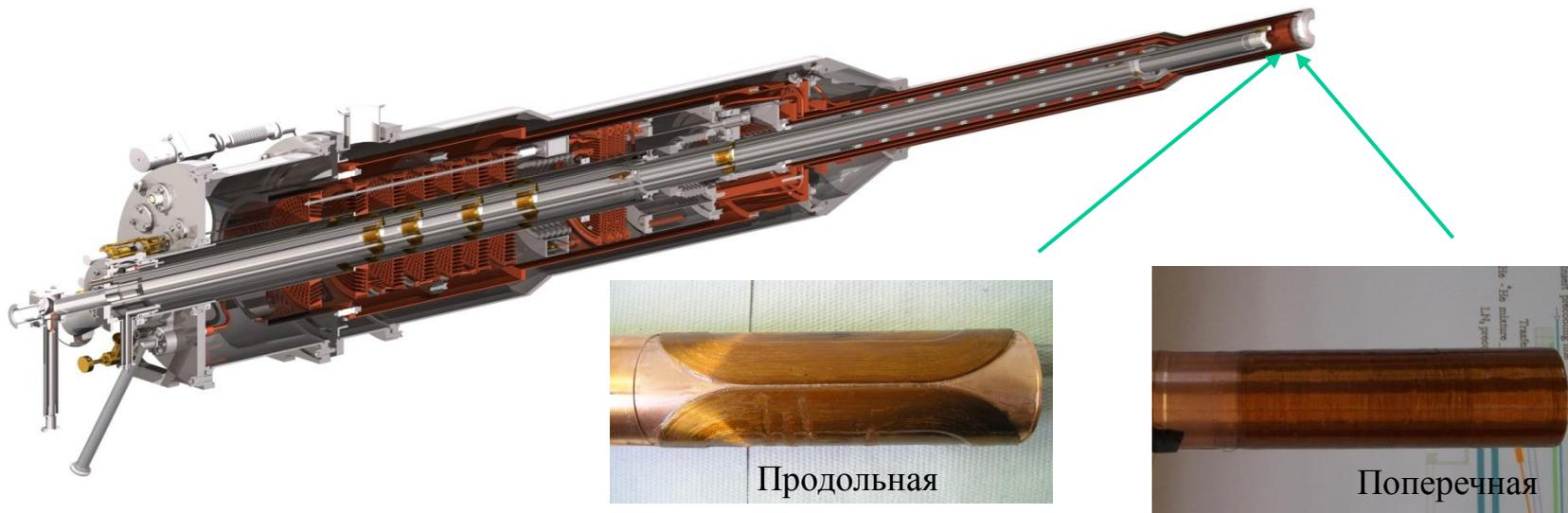
Для создания поляризации замороженных мишеней используются большие магнитные поля (в нашем случае 2.4 Тл) с высокой однородностью поля  $\Delta B/B \sim 10^{-4}$  во всем рабочем объеме мишени, в случае замороженных мишеней для удержания поляризации можно использовать достаточно слабые (0.2-0.5 Тл) поля с невысокой однородностью (около 1%).
