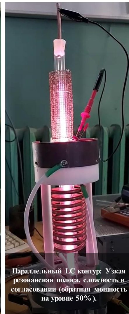
Емкостной диссоциатор: Для полного согласования не хватает индуктивности.
